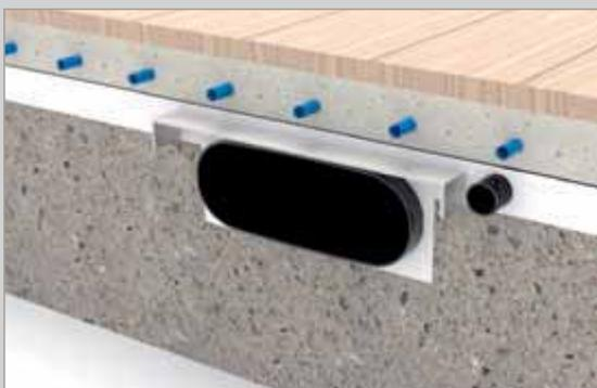
Fachkanal in Trittschalldämmung und Stahlbetondecke mit Bewehrung
